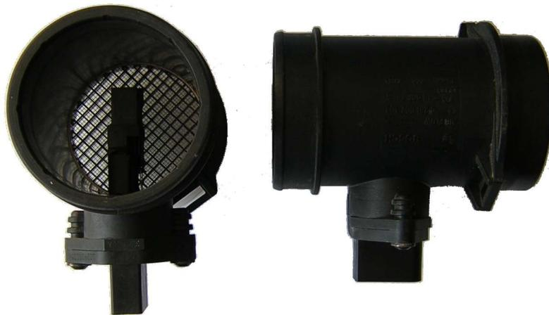
Foto: 80mm Kunststoffluftmassenmesser
