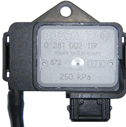
Foto: BOSCH Ladedrucksensor
