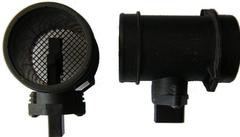
Foto: 80mm Kunststoffluftmassenmesser
